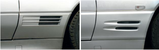
Seitliche Entlüftungsöffnungen („Finnen“) beim Modellstart 1989 (links) und nach der ersten Modellpflege 1995 (rechts)
